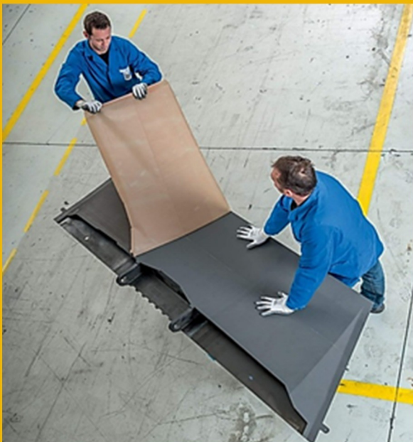
شکل ۲: تصویری از استفاده ی چسب فیلمی در یک سازه
