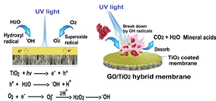
شکل ۴-۱: ساز و کار حذف فوتوکاتالیستی آلاینده‌ها توسط غشاهای فوتوکاتالیستی
