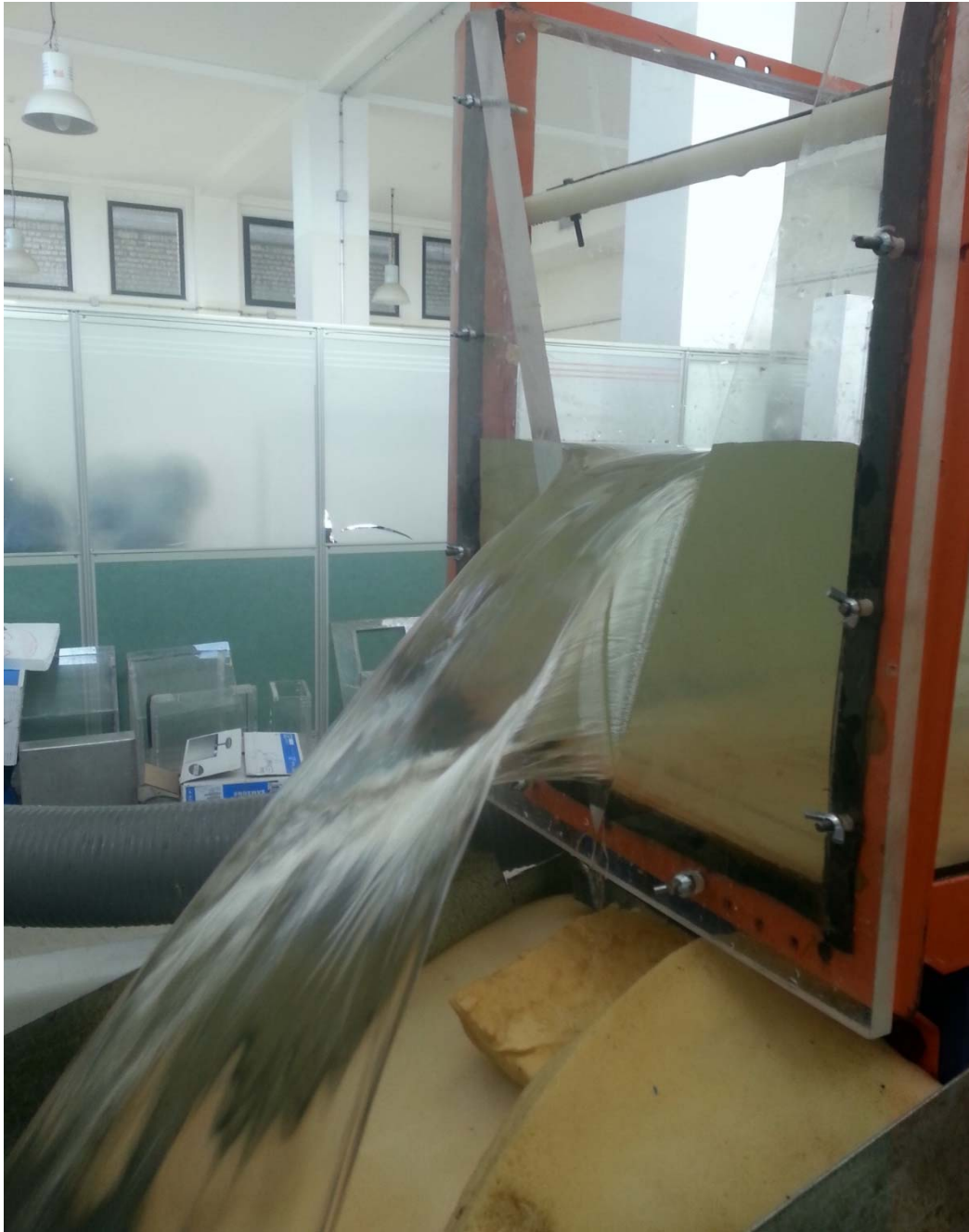
۴. پرش هیدرولیکی: در این دسته آزمایش دانشجویان با نحوه شکل گیری پرش هیدرولیکی و کنترل روابط پرش هیدرولیکی از جمله میزان افت انرژی آشنا می شوند.
