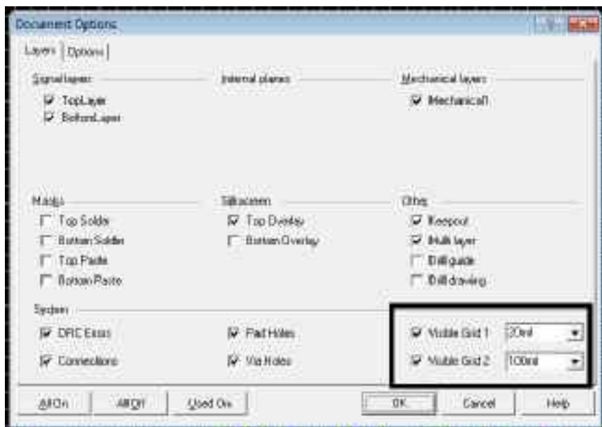
شکل ۴-۳: نحوه تعیین اندازه گریدهای سطح ۱ و سطح ۲ (با انتخاب گزینه ...Options از منوی Design، پنجره فوق ظاهر می شود)
